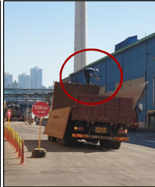
철스크랩 운반차량 덮개 개폐 위치 조정 시 차량 상부에서 추락 위험
