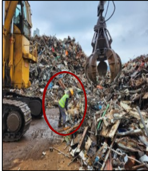
중장비 작업 중 작업반경 내 진입하여 고철 선별
