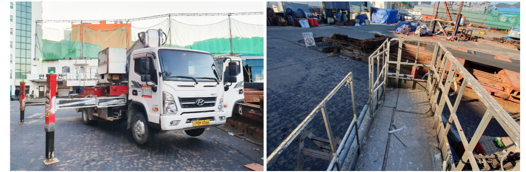
사고 현장에서 사용된 차량탑재형 고소작업대
