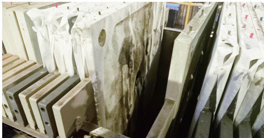
필터 프레스의 여과포. 황산 비철금속 수용액에서 구리, 카드뮴, 비소 등의 부유물을 걸러내는 필터다
