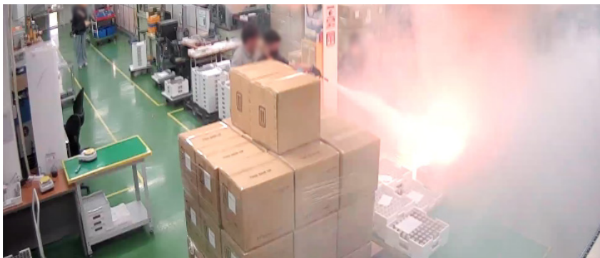
첫 발화를 발견하고 일반 소화기로 진압하는 작업자. 리튬 1차 전지 폭발 시 대피해야한다는 안전 지침을 충분히 교육받지 못했다
