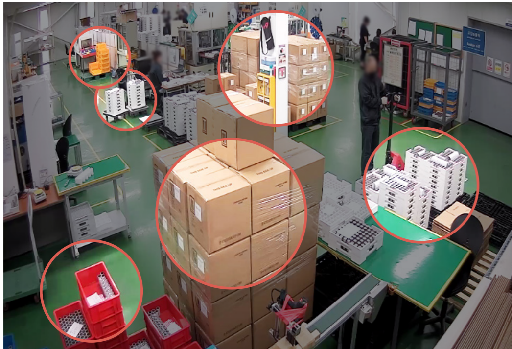
사고 당일, 작업장 곳곳에 리튬 1차 전지가 적재된 모습을 확인할 수 있다
