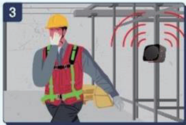
3 일산화탄소 농도가 기준을 초과하여 양생작업장 내부에서 작업 중 경보음 울림시 작업자 양생작업장 밖으로 대피
