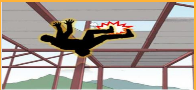
데크플레이트 설치 작업 중 추락 (최근 3년 7명 사망)
