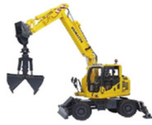
[ 클램셸 장착 굴착기 抓斗挖掘机 ]
