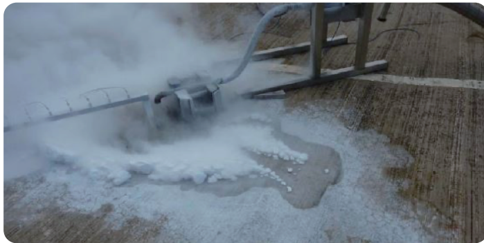
<그림 4> 액화수소가 바닥에 확산되는 상태
