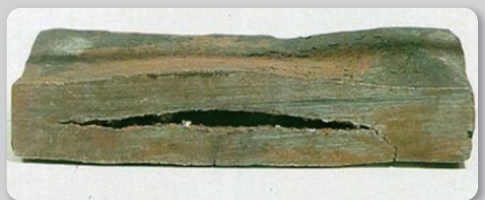
<그림 9> 수소 블리스터링 발생기전(좌), 손상된 금속재료(우)
