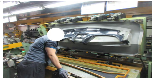
1. 발포액 주입이 되지 않고 발포성형기가 들어옴 2. 동료 작업자가 코어를 장착 후 안전장치를 해제함
