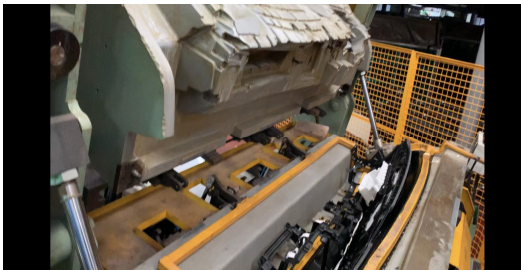
1. 발포액 주입이 되지 않고 발포성형기가 들어옴 2. 동료 작업자가 코어를 장착 후 안전장치를 해제함
