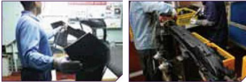
불필요한 부분 제거, 검사 및 조립
