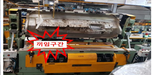
1. 발포액 주입이 되지 않고 발포성형기가 들어옴 2. 동료 작업자가 코어를 장착 후 안전장치를 해제함
