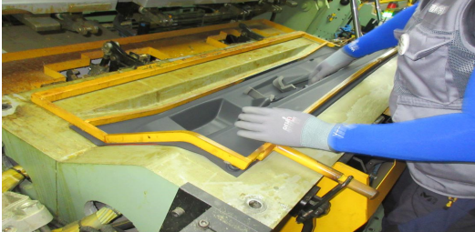
1. 발포액 주입이 되지 않고 발포성형기가 들어옴 2. 동료 작업자가 코어를 장착 후 안전장치를 해제함
