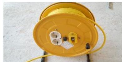
충전부 방호조치 · 누전차단기 설치
