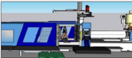
재해자가 사출성형기 내부에 대기한 상태
