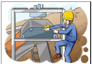
마그네틱 컨베이어 폴리 사이의 이물질 제거 중 끼임
