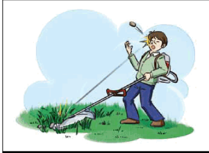
예초기 날 파손 비래
