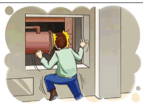
압축기 청소작업 중 끼임
