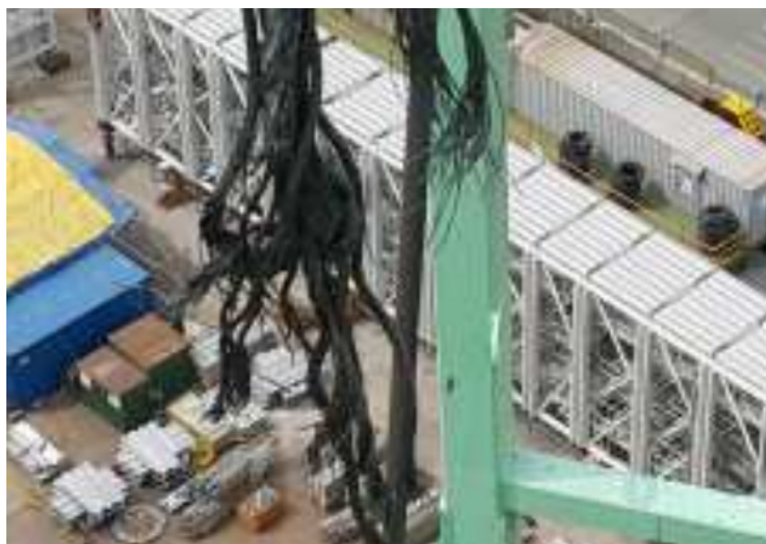
[그림 35] 지브형크레인의 기복용 와이어로프 6가닥이 끊어진 모습
