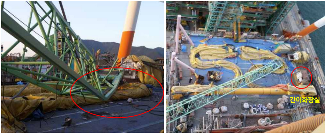
[그림 36] 모듈 메인데크에 지브형크레인 메인지브 등이 떨어진 모습
