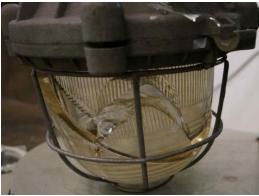
글로브의 충격시험에 의한 파열 모양 (방폭등2와 동일 모델)
