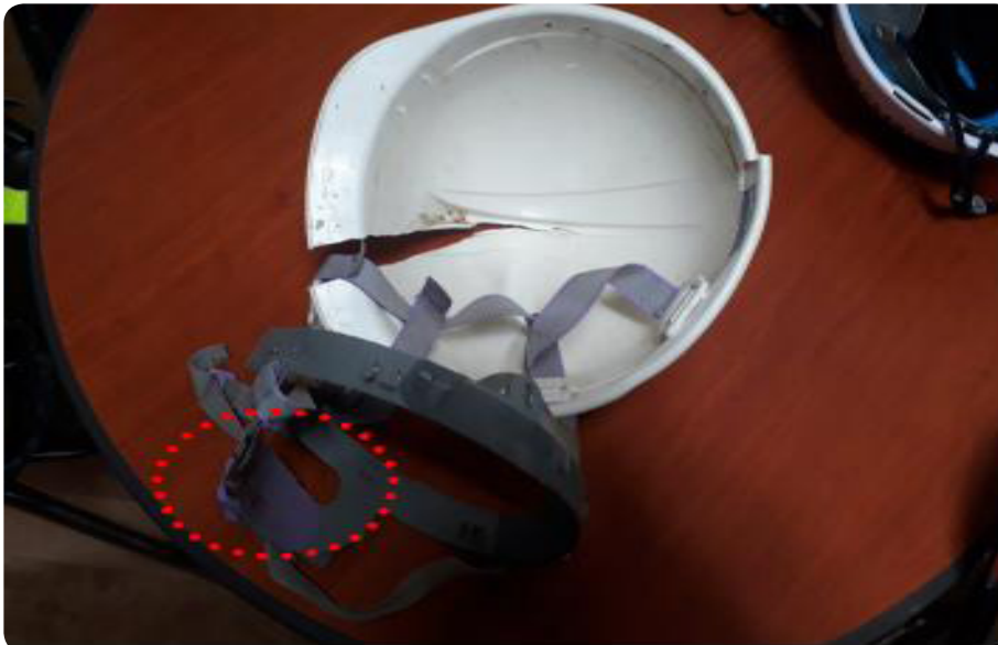
[사진2] 재해자가 착용했던 안전모(충격흡수재 제거된 안전모)
