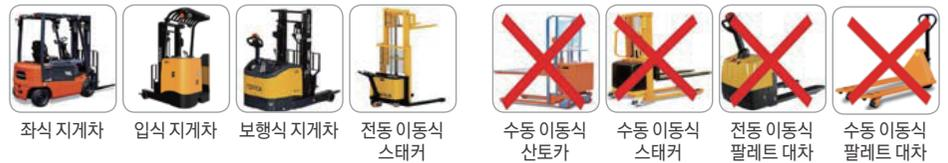
좌식 지게차, 입식 지게차, 보행식 지게차, 전동 이동식 스택커, 수동 이동식 산토카, 수동 이동식 스택커, 전동 이동식 팔레트 대차, 수동 이동식 팔레트 대차
