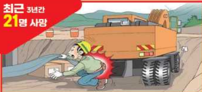
굴착기 작업 중 부딪힘·깔림
