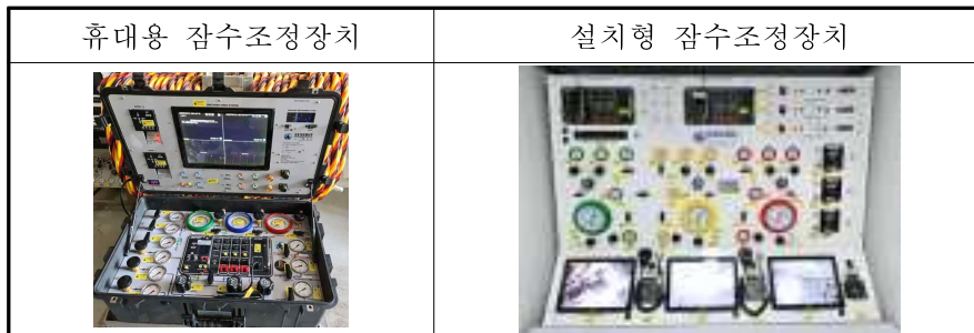
<그림 3> 잠수조정장치(dive control panel)
