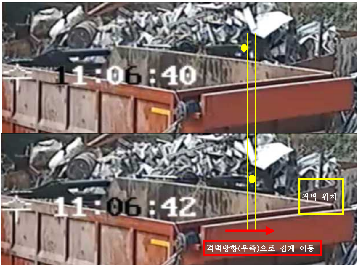
[사진11] 드럼통 하역 직후 격벽 방향으로 이동하는 집게
