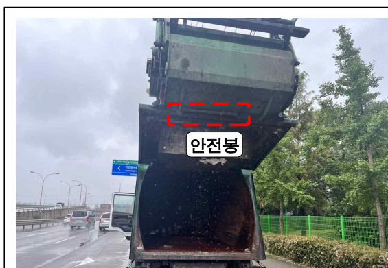
[그림 11] 파카 하부에 설치된 안전봉
