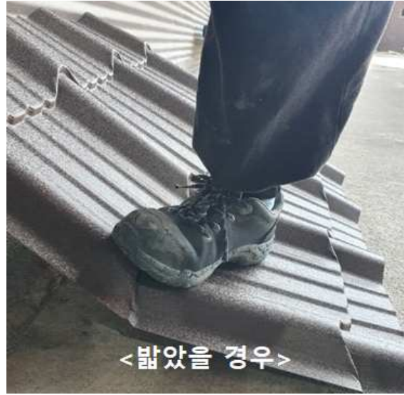
[사진13] 지붕재를 밟았을 때 발생하는 탄성변형(처짐) 시험 [제공 : 제조사]
