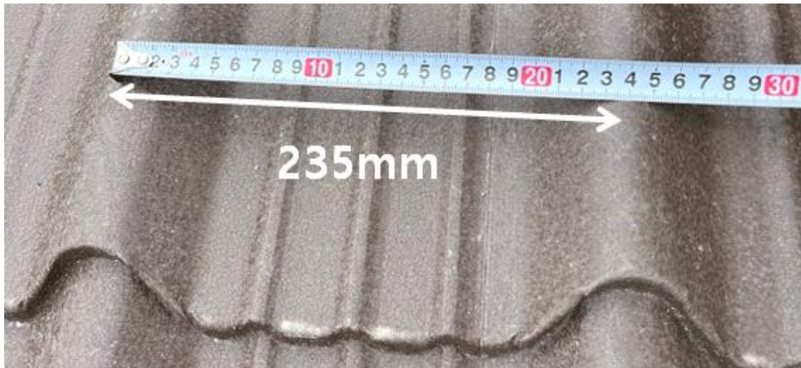
[사진9] 현장에 납품 및 설치된 기와형 칼라강판
