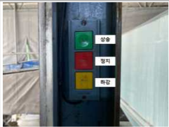
[사진 8] 근로자 탑승 시 조작버튼 작동 모습 [사진 9] 리프트 조작버튼 설치 모습
