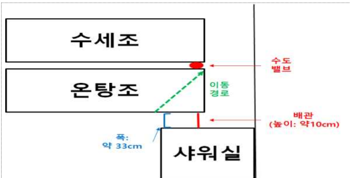
【사진4】 온탕조 및 수도밸브 주변 상세 전경
