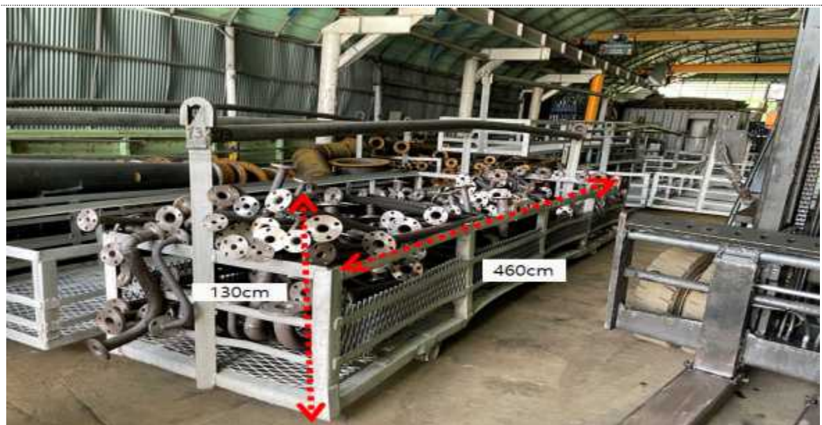
【사진6】 재해당시 건조로 상부에 크레인에 걸려있던 적재용 지그(3번)
