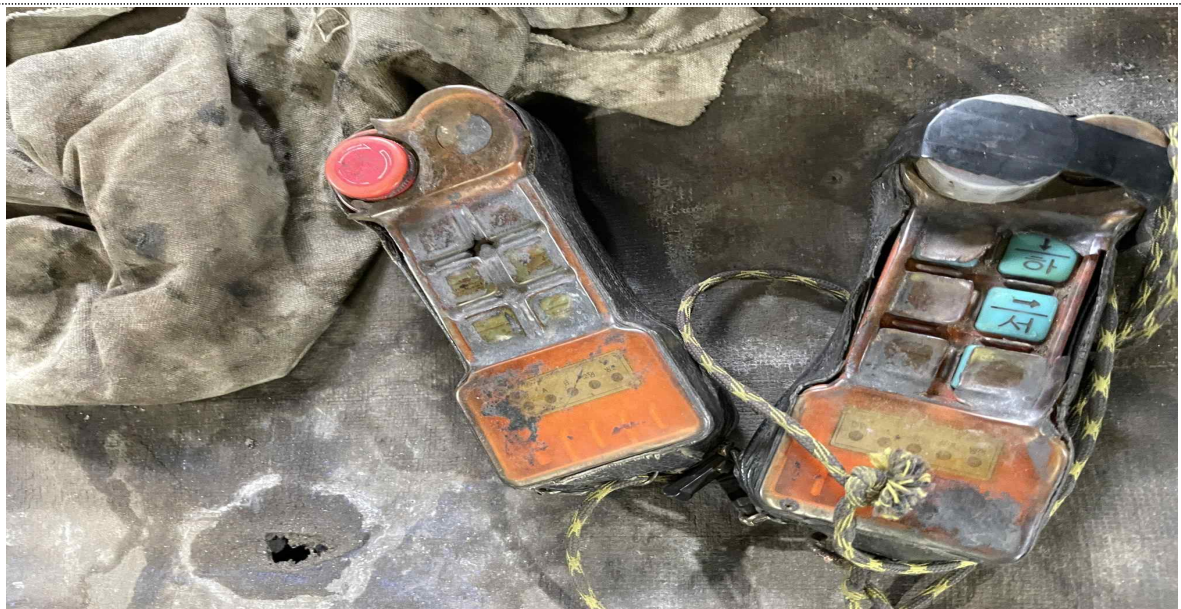
【사진8】 재해자가 사용한 크레인 무선원격제어기
