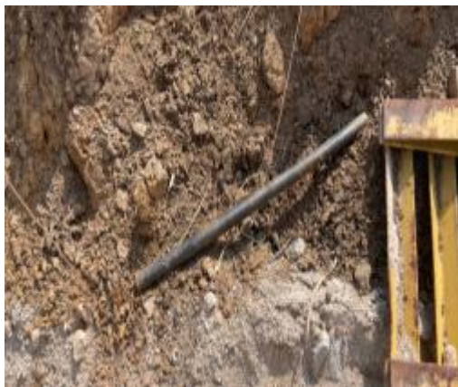
[사진6] 슬링벨트 고정에 사용 된 핀 (길이 85cm, 지름 \varnothing 3cm)
