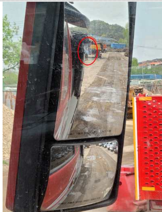
[사진 6] 우측 후사경 확인 (후방 약 23.5m 지점부터 근로자 식별 가능)
