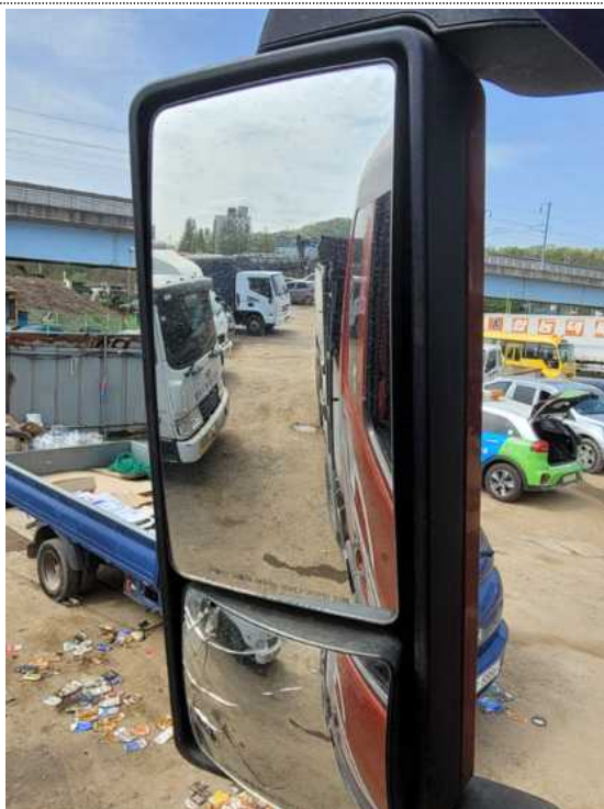
[사진 5] 좌측 후사경 확인 (후방 약 23.5m 지점 근로자 식별 불가)
