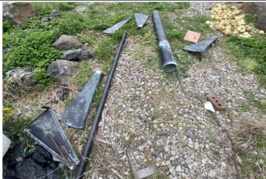
[사진9] 바닥으로 던져진 절단된 계단판 및 안전난간
