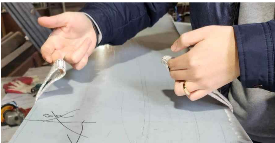
[사진5] 슬링벨트 1개는 길이가 짧아 혹에 체결 불가능
