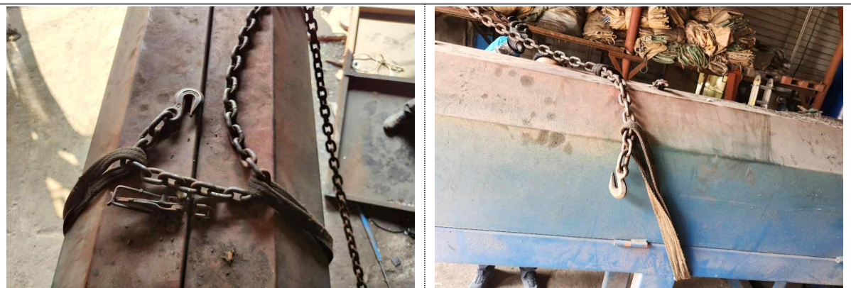
[사진 21] 혹 미체결 상태에서 체인슬링 장력 발생 시 모습 재연
