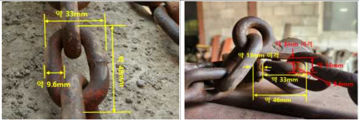
[사진 7] 작업에 사용된 줄걸이 용구(체인슬링 제원 등)
