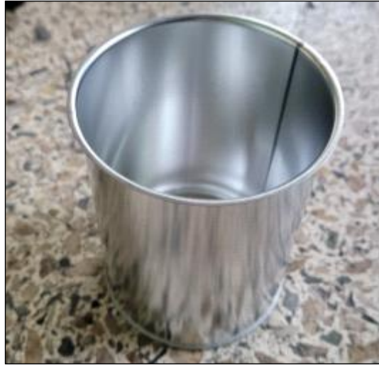
[사진 5] 금속 재질의 샘플링 용기 (500 ml, ID 85mm * H 110mm)
