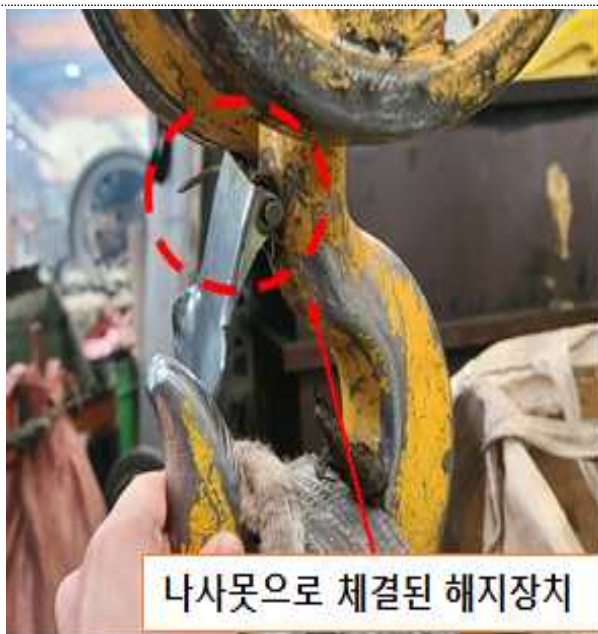
【사진 10】 사고 발생 크레인의 해지장치 체결핀 상태
