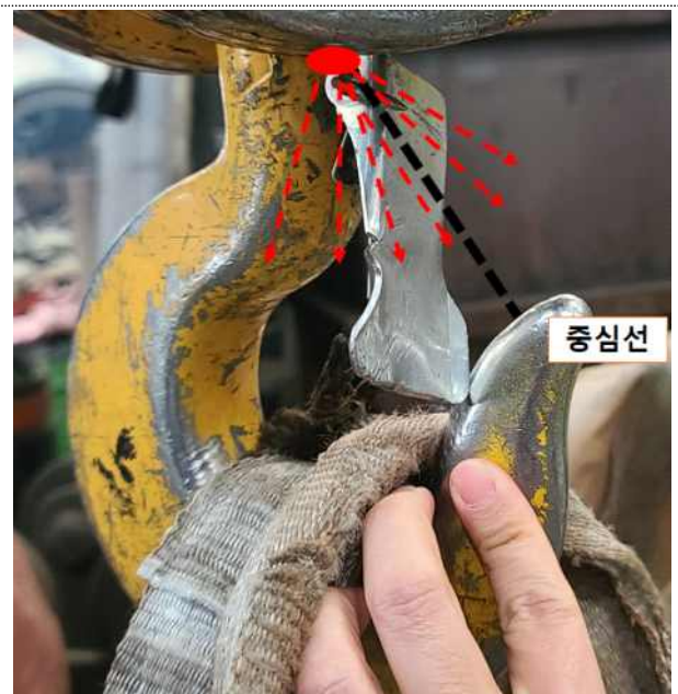
【사진 11】 혹 해지장치가 혹 선단 중심부위 안쪽에서 벗어나 움직이는 모습 (초동조사 당시 상태)
