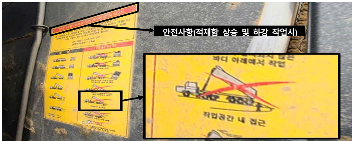
[재해발생현장 덤프트럭에 부착된 적재함 상승 및 하강 작업 시 안전사항]
