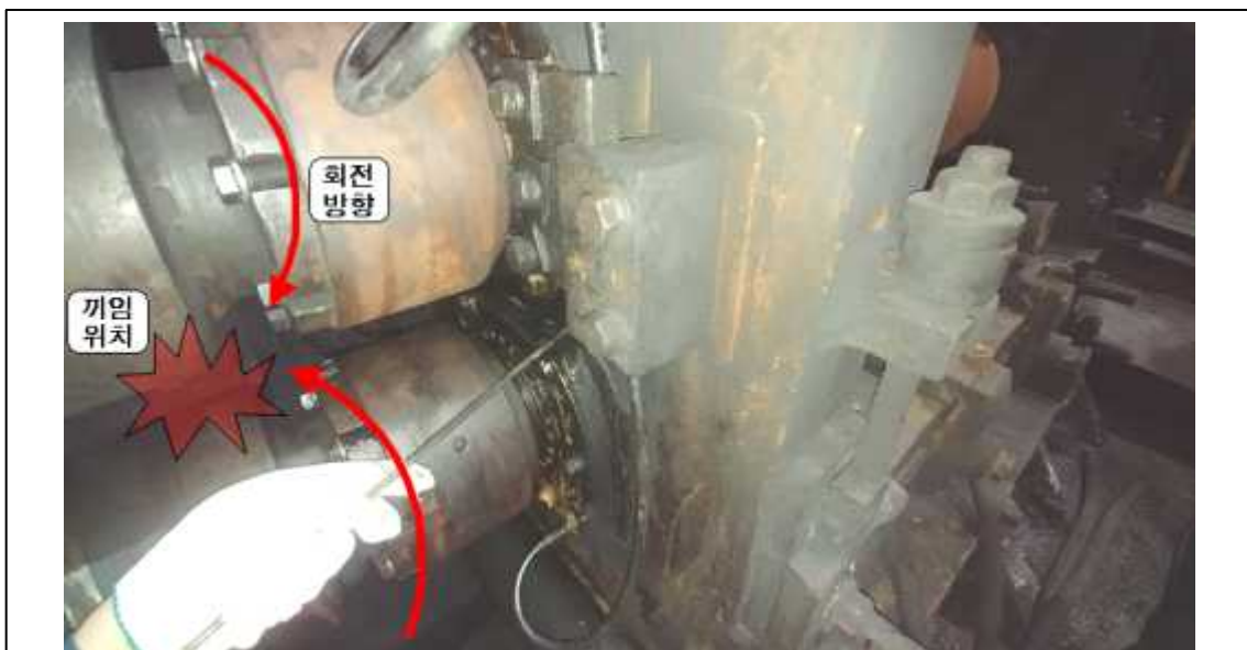
[그림 12] 베어링 케이스 사이로 와이어(시편)를 넣는 모습(재연)
