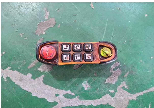
【사진5】사고발생 당시 사용한 무선원격제어기
