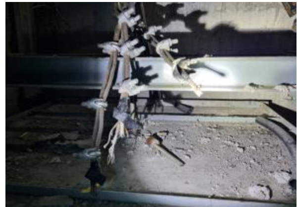
【사진5】 덤웨이터 운반구에 연결된 와이어로프 절단부위
