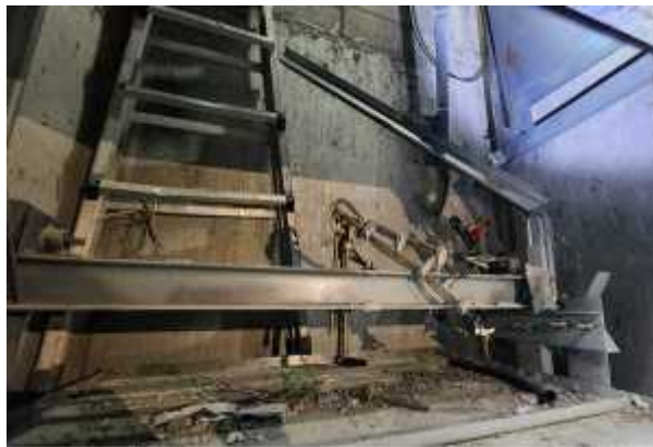
【사진5】 덤웨이터 운반구에 연결된 와이어로프 절단부위
