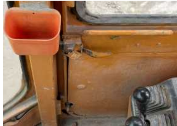
【사진4】 운전석 우측문 내부 잠금장치(정상)
