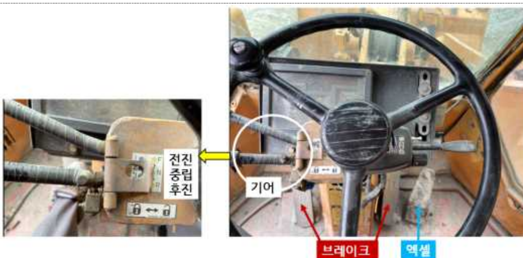
【사진8】 기어, 브레이크, 엑셀 설치상태
