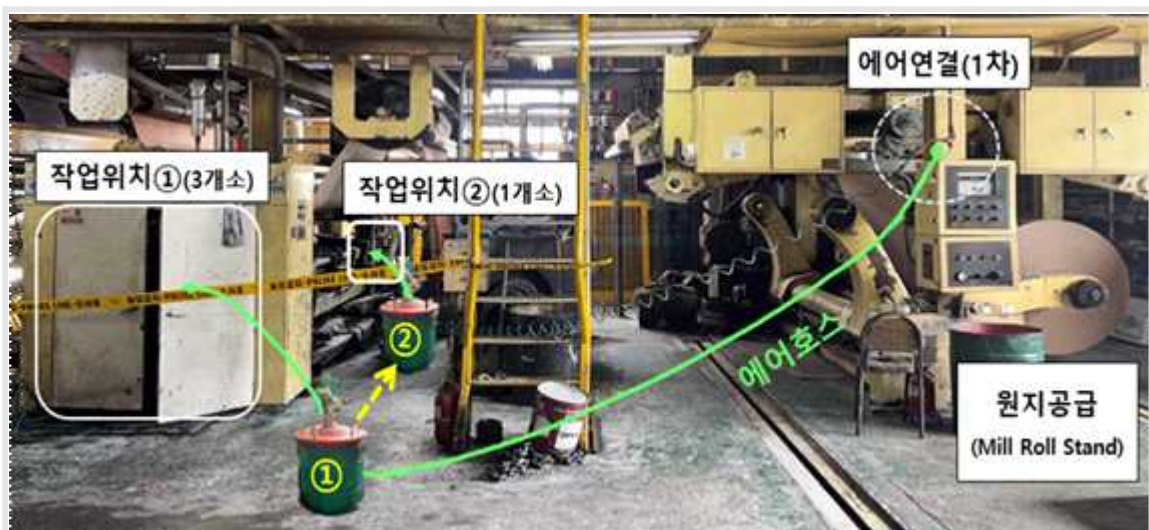
재해발생 전 구리스 주입작업 위치 및 구리스 펌프 이동경로
