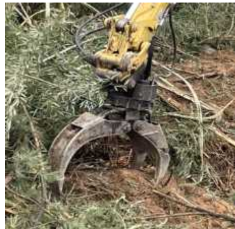
(사진5) 굴착기가 사용하던 집게: 선택작업장치(Attachment)
