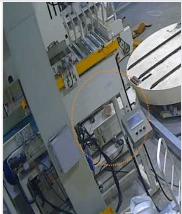
【재해발생】 턴테이블 낙하에 의해 끼임(CCTV)
