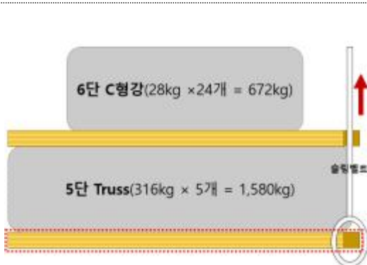
[그림 7]고임목 들기 전 상태[배면도]
