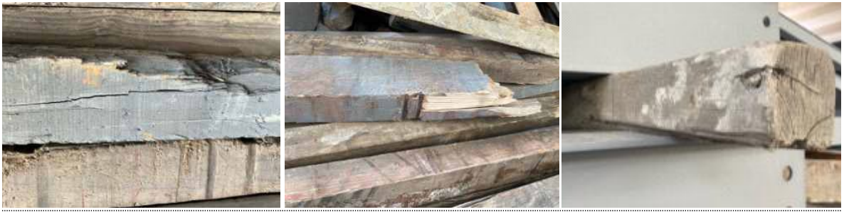
[사진 11] 사업장 사용 중인 고임목 상태(확대)
