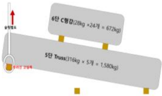
[그림 6]고임목 든 상태[우측면도]
