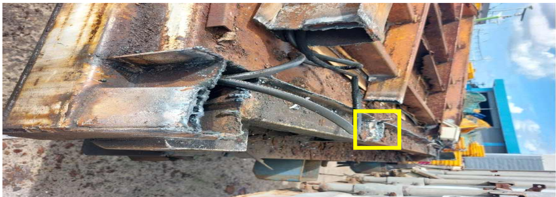
[사진 6] 형강, 프레임, 철판 하부는 전체적으로 용단되어 있으나, 중간프레임 안쪽면 만이 파단 흔적이 있음
