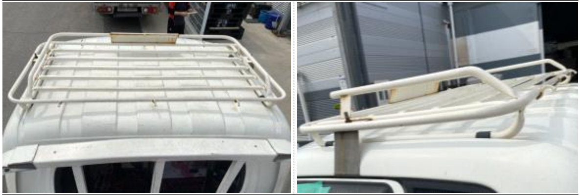
[사진 9] 재해발생 화물자동차 캡(재해자 위치)에 설치된 루프 랙
