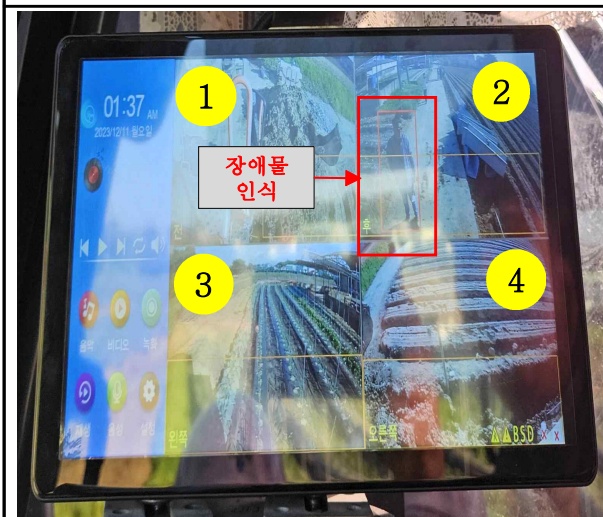
[사진 9] 모션 인식 카메라(재해발생 후 시연)
