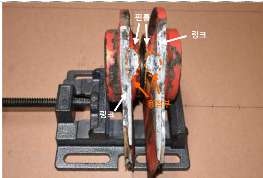
【사진17】 링크, 핀홀 용접 부위(국과수 감식 사진 참조)
