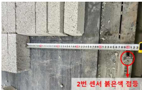
[사진 8] 2번 센서 벽돌 감지 상태 (재현)
