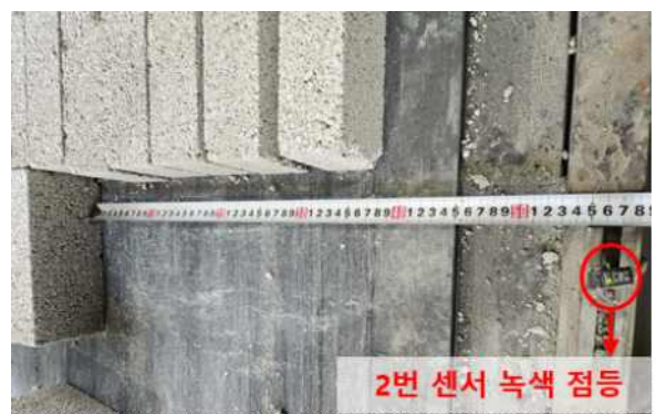
[사진 9] 2번 센서 벽돌 미감지 상태 (재현)
