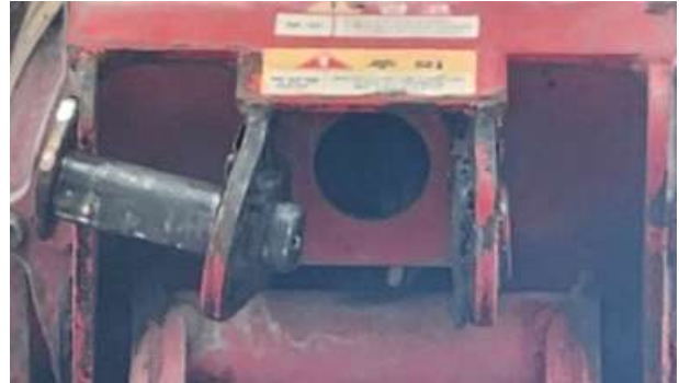
[그림 9] 연결핀 정상 조립상태 및 사고 후 상태
