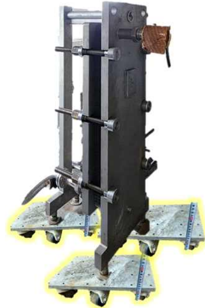
[사진15] 열교환기 이동작업 예시
