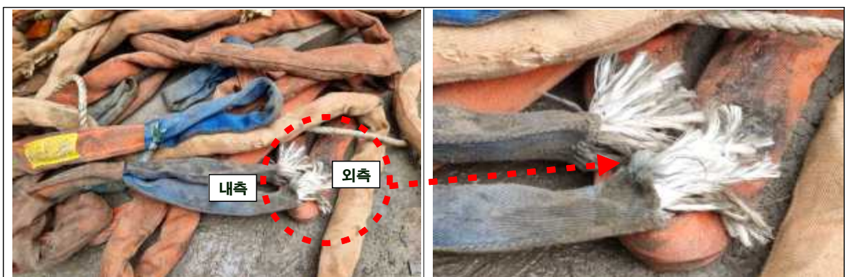
【사진 8】 라운드슬링 고리부 외피(Cover)와 심(Core) 파단상태('24.2.6 현장제공)
