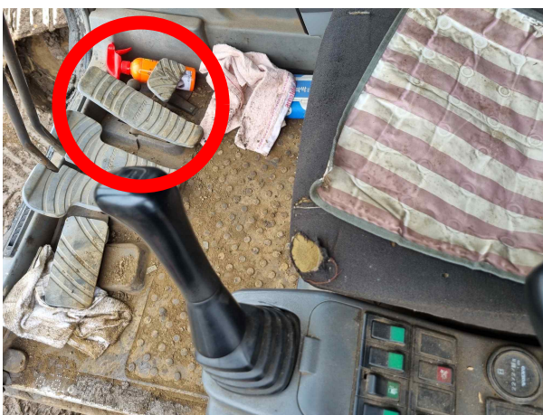
<사진 7> 집게회전 작동페달 및 구동 유압라인
