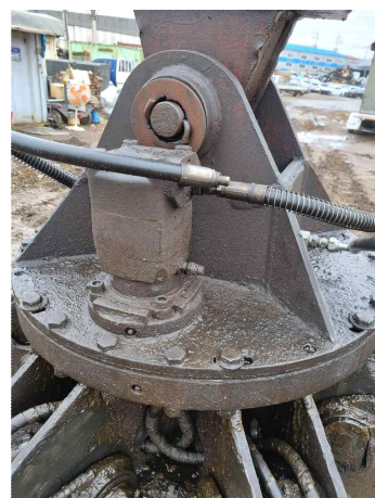
<사진 7> 집게회전 작동페달 및 구동 유압라인
